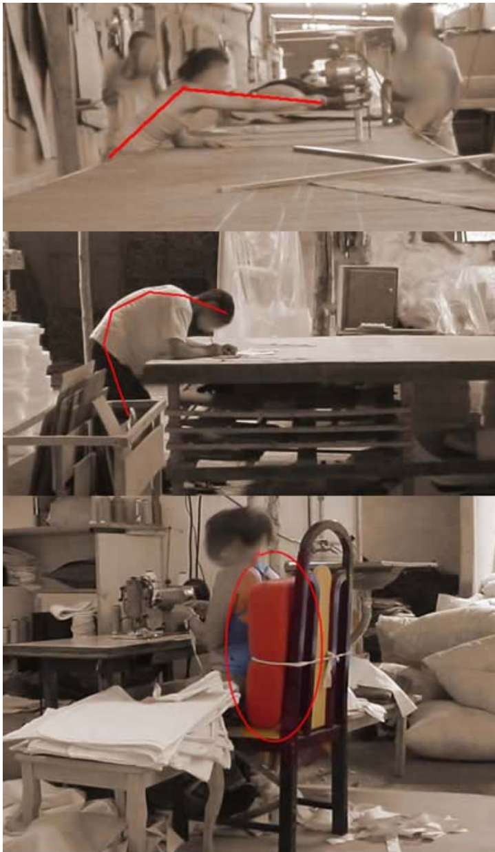
Figura 2 – Imagens das observações dos elementos ergonômicos -Postos de Trabalho inadequados
