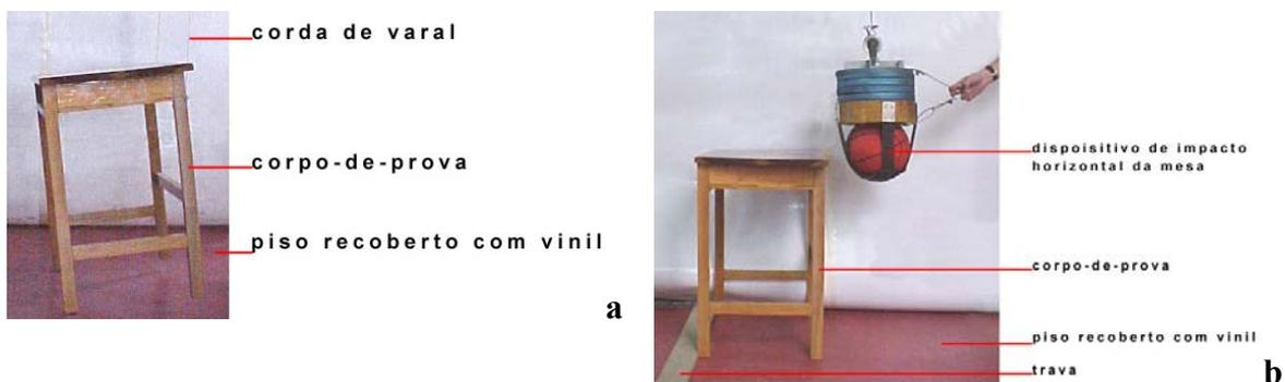
Figura 14 - Fotos dos ensaios de (a) de tombamento e (b) impacto nas bordas da mesa
