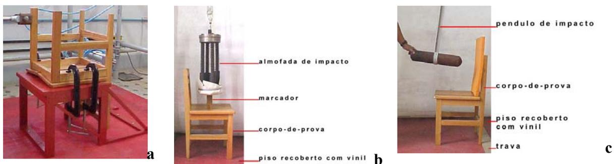
Figura 8 - Fotos dos ensaios (a) de carga em uma perna frontal da cadeira, (b) de impacto no assento e (c) de impacto no encosto
